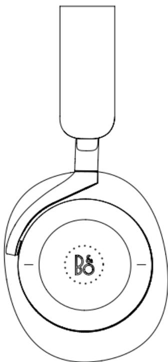
使用右耳罩上的触摸铝制表盘控制通话。
