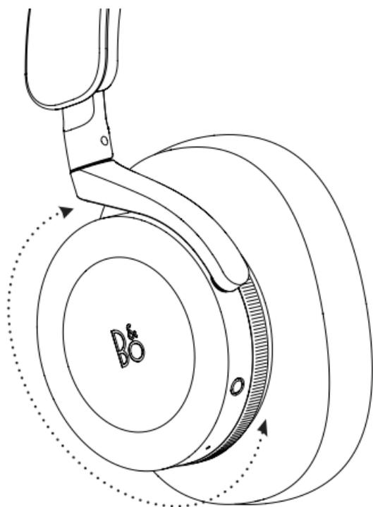
旋轉左耳罩的旋盤以在「主動式雜音消除」和「透明度」模式之間進行調整。
