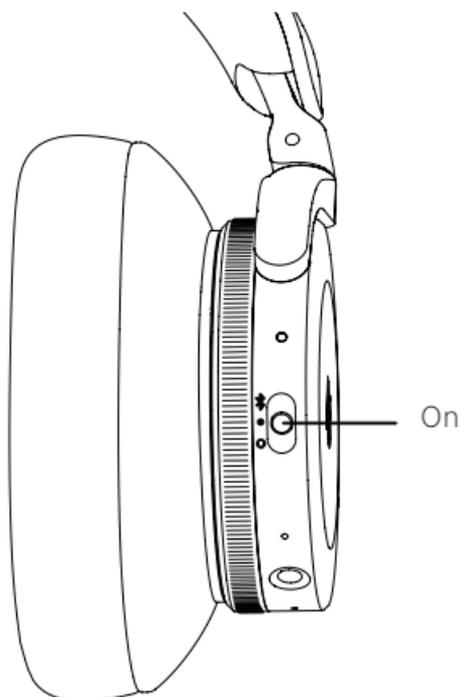
将开关切换到 ON 位置以打开耳机。如需关闭，请将开关切换到 OFF 位置。耳机闲置时间超过 15 分钟后会自动关闭。Beoplay H95 会记住上次连接的设备。耳机打开时，会尝试重新连接到上次配对的设备。
