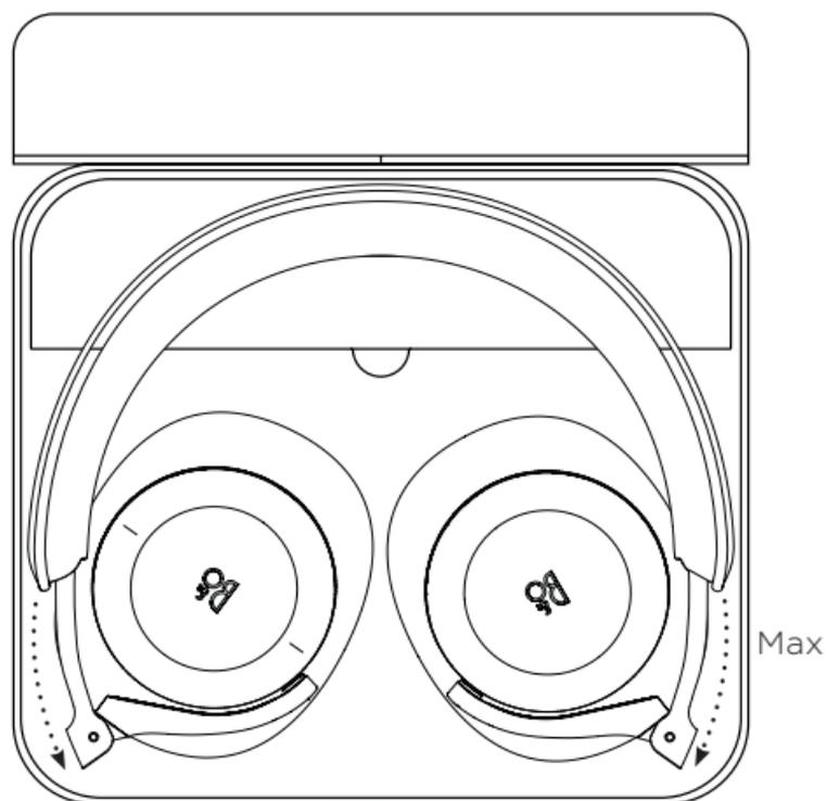
Om du vill förvara hörlurarna i fodralet ska du se till att glidskenorna är helt utdragna, vrida på hörlurarna så att de ligger platt och vika hörlurarna mot huvudbandet.
