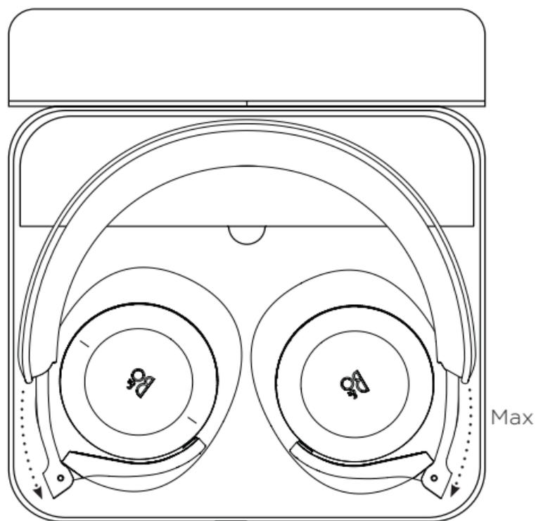
ヘッドフォンをケースに保管するには、スライダーが完全に引き出されていることを確認し、イヤークップを回転させて平らにして、イヤークップをヘッドバンドに向かって折りたたみます。
