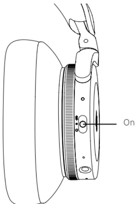
ヘッドフォンの電源をオンにするには、スイッチをONの位置に移動します。電源をオフにするには、スイッチをOFFの位置に移動します。15分間使用されなかった場合、ヘッドフォンは自動的にオフになります。Beoplay H95は、以前接続されたデバイスを記憶しています。電源がオンになると、以前ペアリングされたデバイスへの再接続を試行します。
