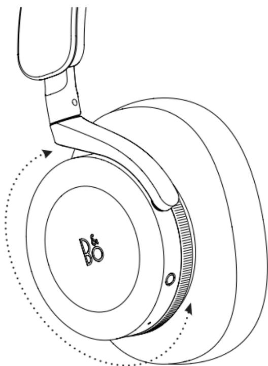
Faites tourner le cadran sur l'écouteur gauche pour passer du mode Réduction active du bruit au mode Transparence.
