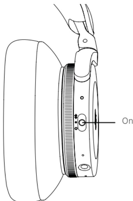
Mettez l'interrupteur en position ON pour allumer le casque. Pour l'éteindre, mettez l'interrupteur en position OFF. Le casque s'éteint automatiquement s'il n'est pas utilisé pendant 15 minutes. Le Beoplay H95 garde en mémoire les appareils qui ont déjà été couplés. Lorsqu'il est allumé, il tente automatiquement de se reconnecter à ces appareils.
