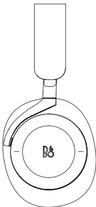
Du styr hörlurarna med hjälp av touchgränssnittet av aluminium på den högra hörluren och vreden på varje hörlur.
