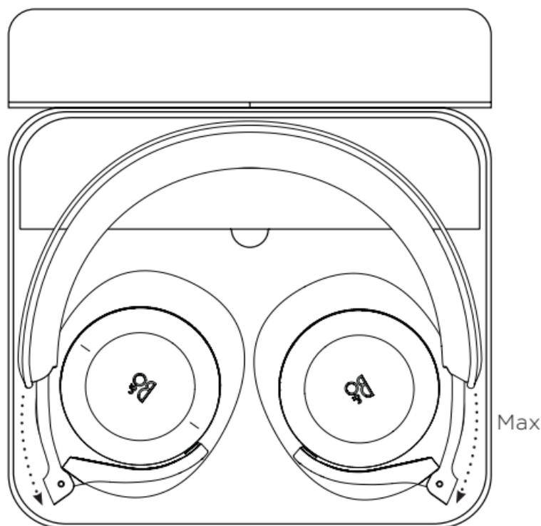
Vor der Aufbewahrung der Kopfhörer in der Tragetasche sollten Sie sich vergewissern, dass die Schieber vollständig herausgezogen sind, und dass die Hörmuscheln sich in einer flachen Position befinden und in Richtung des Kopfbands gedreht sind.
