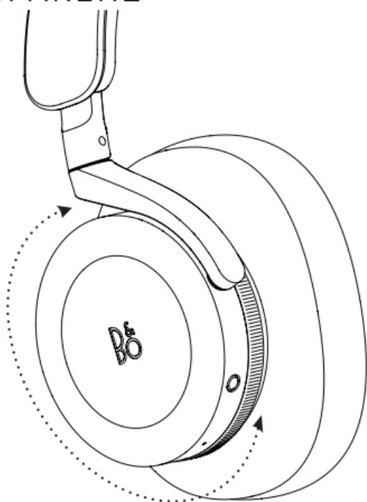
Drehen Sie den Drehregler an der linken Hörmuschel, um das Verhältnis zwischen aktivem Geräuschunterdrückungs- und Transparenzmodus einzustellen.
