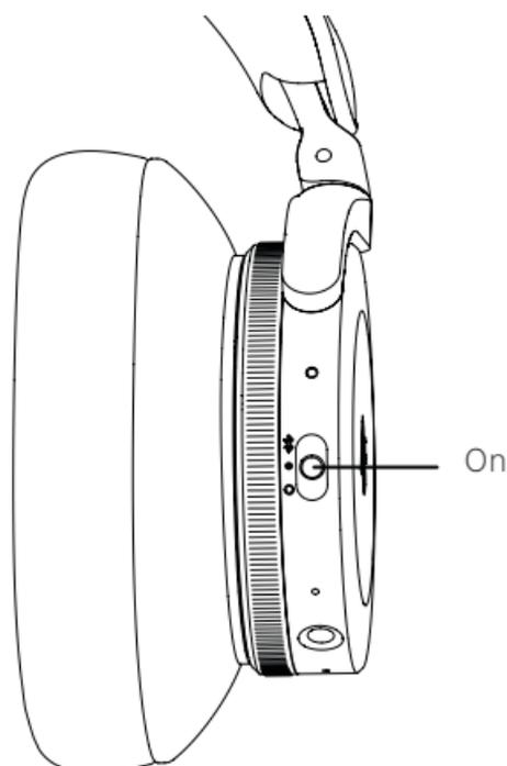
Переведите переключатель в положение ВКЛ, чтобы включить наушники. Для выключения переведите переключатель в положение ВЫКЛ. Наушники автоматически отключатся при отсутствии действий с ними в течение 15 минут. Beoplay H95 запоминает ранее подключенные устройства. При включении будет выполнена попытка повторного подключения к ранее сопряженным устройствам.
