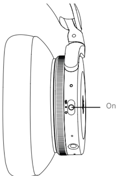
Stellen Sie den Schalter auf die Position „ON“ (EIN), um die Kopfhörer einzuschalten. Zum Ausschalten stellen Sie den Schalter auf die Position „OFF“ (AUS). Die Kopfhörer werden nach 15 Minuten Inaktivität automatisch ausgeschaltet. Beoplay H95 merkt sich zuvor verbundene Geräte. Nach dem Einschalten versucht das Gerät, die Verbindung zu zuvor gekoppelten Geräten wiederherzustellen.
