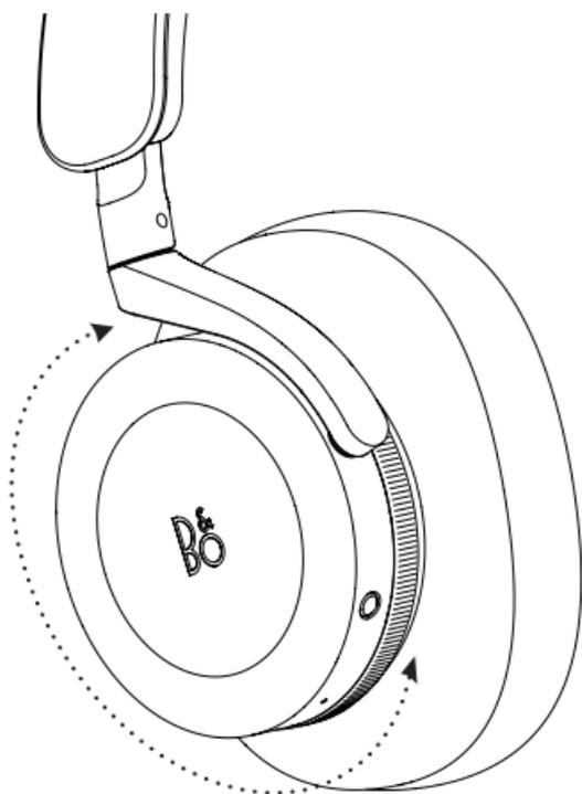
旋转左耳罩上的旋钮，以在“主动消噪”和“透明度”模式之间调整。
