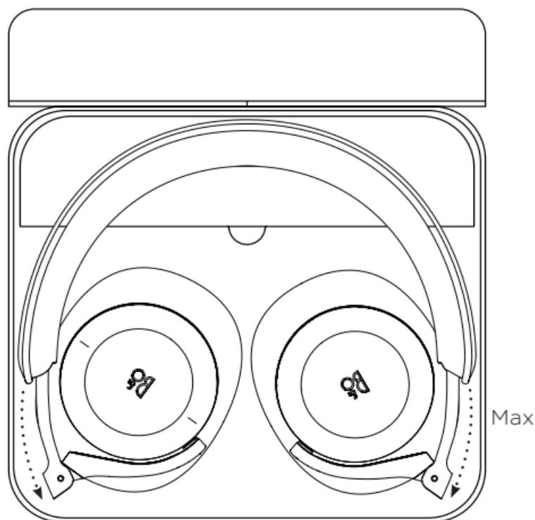
Para guardar los auriculares en el estuche, asegúrese de que los deslizadores estén completamente extendidos, gire los auriculares para que queden planos y pliéguelos hacia la banda de sujeción. Hay espacio para el cable mini-jack, el cable de carga y el adaptador de vuelo dentro del compartimento del maletín de transporte.
