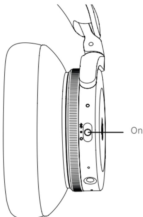
Sätt på hörlurarna genom att föra reglaget till läget PÅ. Stäng av dem genom att föra reglaget till läget AV.
