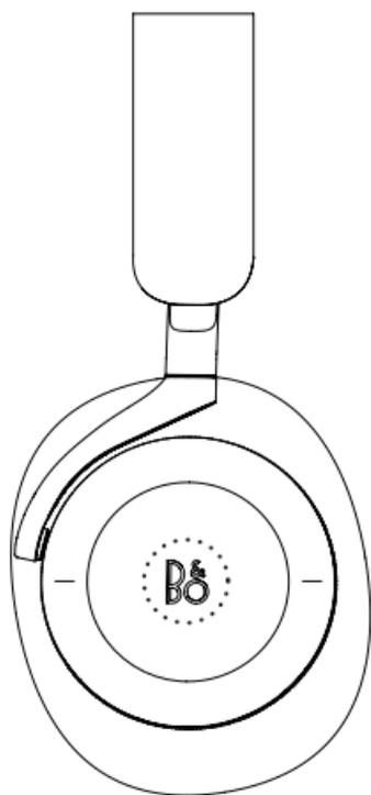
Per controllare le chiamate, usa il disco a sfioramento in alluminio sul padiglione destro.
