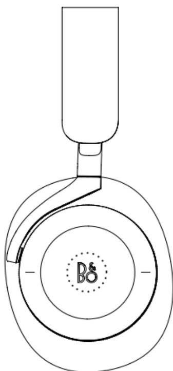
Använd touchgränssnittet av aluminium på höger hörlur för att styra samtal.
