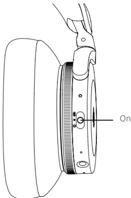
Desloque o botão para a posição ON para ligar os auscultadores. Para desligar, desloque o botão para a posição OFF. Os auscultadores desligar-se-ão automaticamente quando não forem utilizados durante 15 minutos. O Beoplay H95 lembra-se de dispositivos previamente ligados. Quando o ligar, tentará ligar-se novamente a dispositivos previamente emparelhados.
